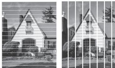
清洗打印头喷嘴后，线条消失。
