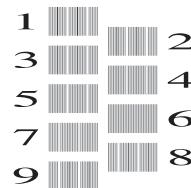
**6** 对于 (A) 样式，按 ▲ 或 ▼ 显示垂直线条清晰度最低的打印图样的编号 (1 ~ 9)，然后按所显示编号 (在上述示例中，编号 6 是最佳选择)。按 [确定]。
