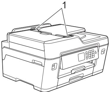
**3** 如示意图所示，将原稿以正面朝上的方式放入自动进稿器中，直到您感觉到原稿碰到进纸辊并且设备发出提示音。
