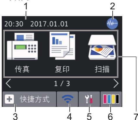
当设备闲置时，此屏幕显示设备状态。主页屏幕也称为就绪模式屏幕。显示此屏幕时，表示设备准备就绪可执行下一个命令。
