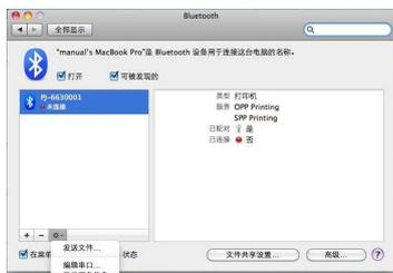
3 选择 [端口类型] (10.4.11) / [服务] (10.5.x-10.6) 下拉菜单中的 [RS-232], 选择 [设备服务] (10.4.11) / [协议] (10.5.x-10.6) 下拉菜单中的 [SPP Printing], 然后单击 [应用]。
