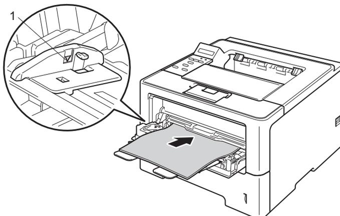
**4** 抬起支撑翼板以防止纸张从出纸托板中滑落，或者在打印后立即取走每张纸。
