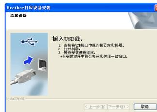
**e** 将 USB 接口电缆一端插入设备上标有
