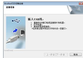
**e** 将 USB 接口电缆一端插入设备上标有
