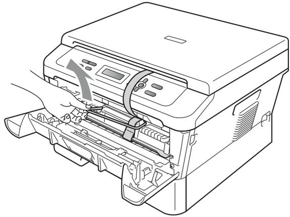
**e** 如图所示，拉出纸带，取出保护材料。
